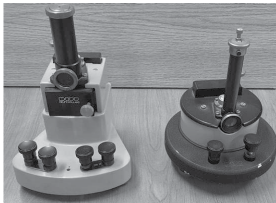
Εικόνα 12. Γαλβανόμετρα (Galvanometers) κινούμενου κατόπτρου. Κατασκευαστής: Kipp & Zonen, Delft-Holland (1930-1960).
