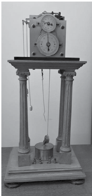
Εικόνα 9. Χρονοσκόπιο Hipp. Κατασκευαστής: E. Zimmermann, Leipzig-Berlin, περίπου 1900.
